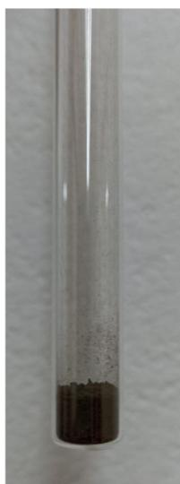
Figura 4.1: Roca shale molida y contenida en un tubo de ensayo de 10 mm de diámetro.
