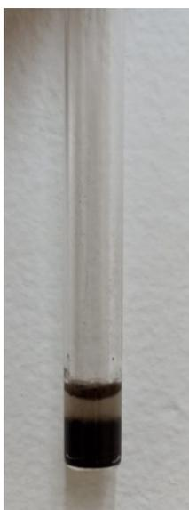
Figura 4.2: Roca shale molida y contenida en un tubo de ensayo de 10 mm de diámetro, con el agregado de agua destilada. Se puede observar la separación de las fases.
