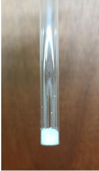
Figura 3.2: Adamantano molido introducido en un tubo de ensayo de 10 mm de diámetro.
