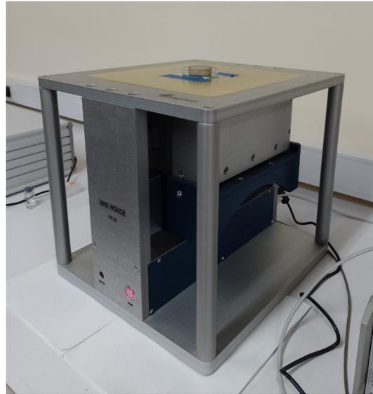
Figura 3.2: NMR-MOUSE de Magritek, sobre la parte superior se puede ver la muestra ubicada en la zona sensible.
