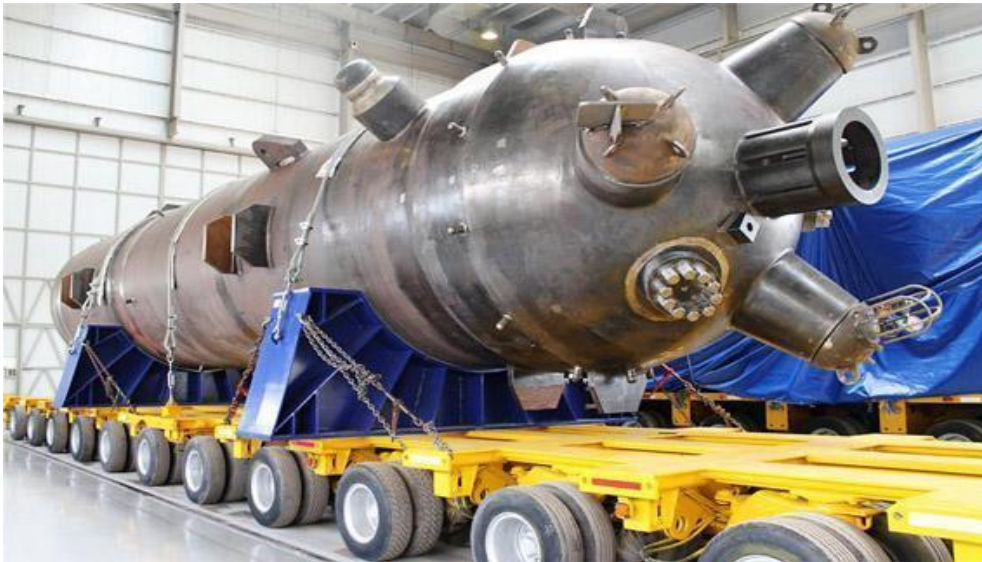
Figura 3.2.6.a: Cambio de Boilers principales. Fuente: Nucleoeléctrica Argentina S.A.
