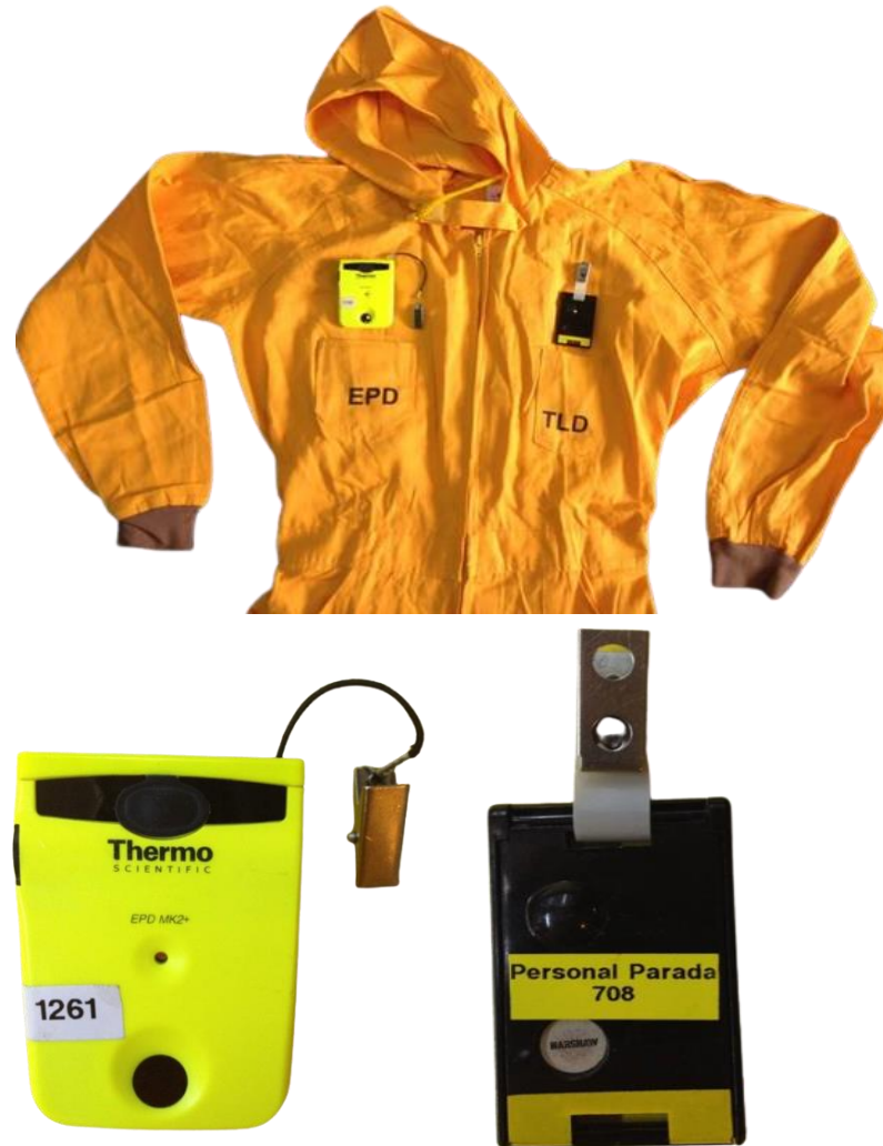
Figura 5.1.3.a: Elementos de radioprotección. Fuente: Central Nuclear Embalse.
