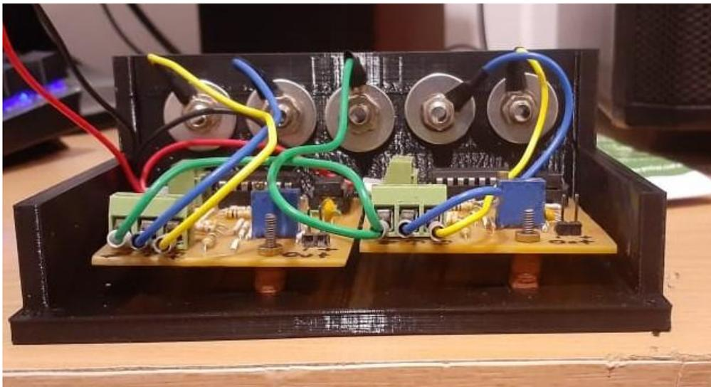
Figura 73: Montaje de las placas sobre la parte superior de la carcasa. Vista frontal
