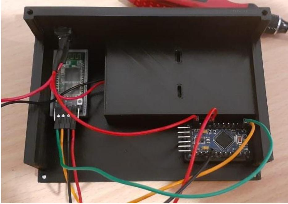
Figura 76: Montaje del Módulo Bluetooth y el Arduino Pro Mini en la parte inferior de la carcasa donde se muestra el conexionado entre estos componentes.
