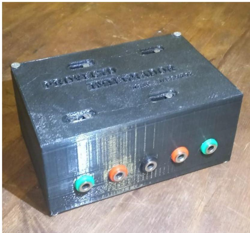
*Figura 80: Diseño final de la carcasa montado y cerrado.*
