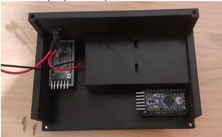
*Figura 75: Montaje del Módulo Bluetooth y el Arduino Pro Mini en la parte inferior de la carcasa.*
