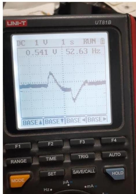
*Figura 82: Señal de una mirada hacia la derecha (Dextroversion)*
