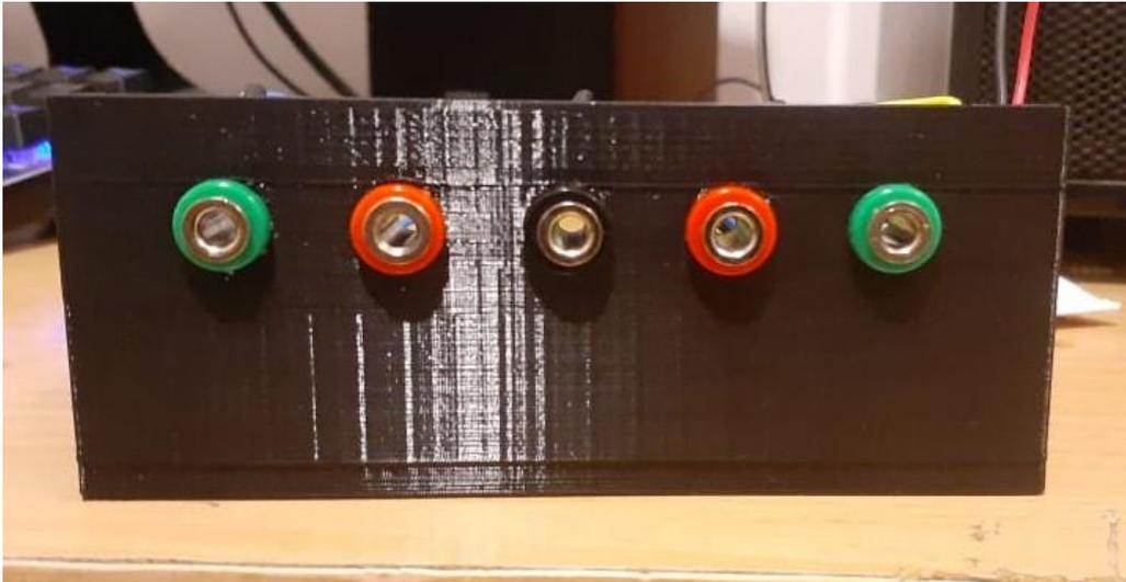
*Figura 74: Montaje de los conectores banana hembra en el lateral de la carcasa.*
