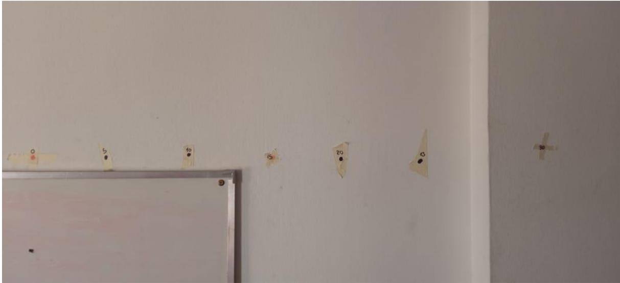
*Figura 88: Puntos colocados en la pared para estandarizar las medidas. Estos se calcularon utilizando trigonometría a una distancia de 1.6m de la pared.*
