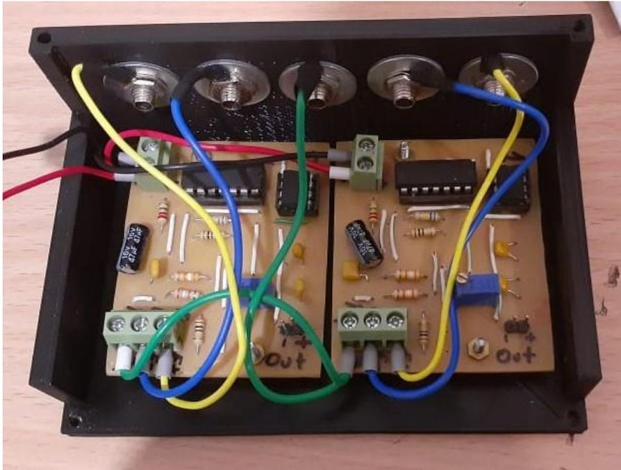
Figura 72: Montaje de las placas sobre la parte superior de la carcasa. Vista superior
