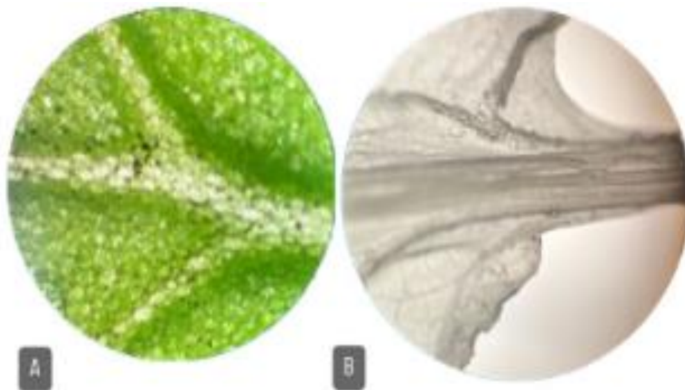
Figura 18: Micrografías de hoja de espinaca A) sin descelularizar y B) andamio descelularizado (10x).
