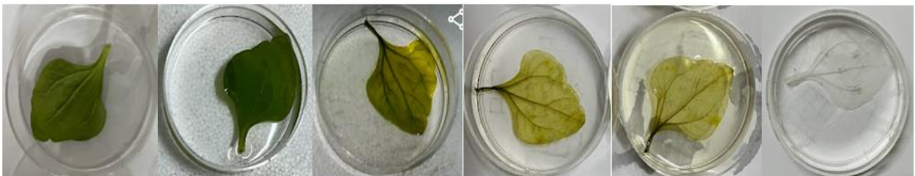
Figura 16: Etapas del proceso de descelularización. a: Antes de iniciar; b, c, d y e: etapas intermedias del protocolo con decoloración parcial y árbol vascular conservado; f: El proceso finalizado.
