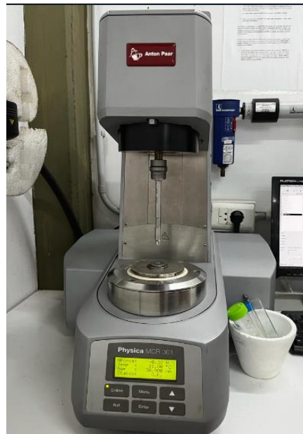
Figura 12: Reómetro Rheoplus con geometría colocada y hoja decelularizada presentada para comenzar el estudio.
