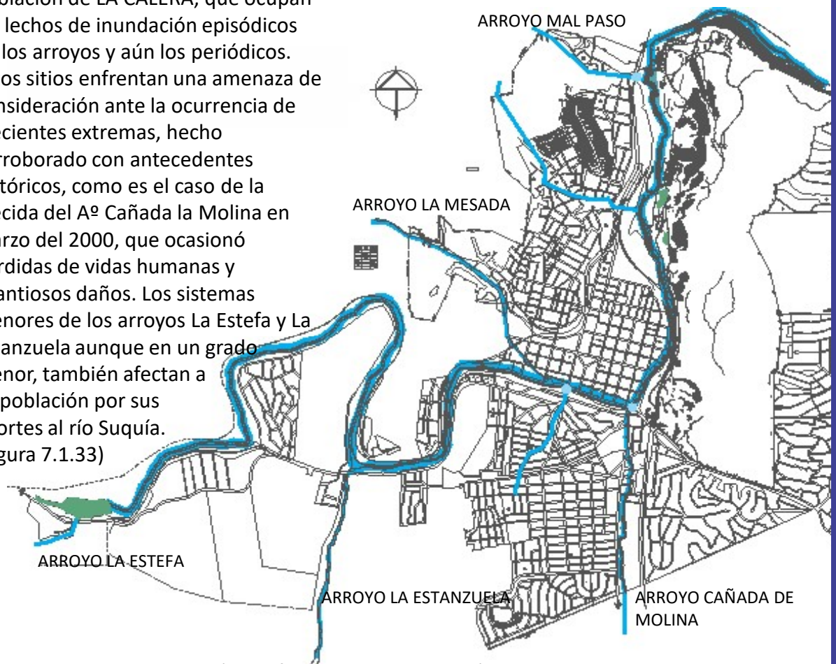
Figura 7.1.33 Sistema hidrológico referenciando los arroyos más importantes en cuanto a crecidas de caudal.
