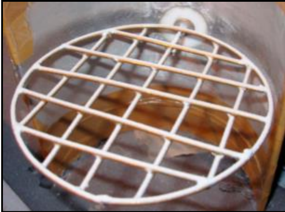
Figura 2.3. Rejilla Metálica acrecida. Granizo Artificial.
