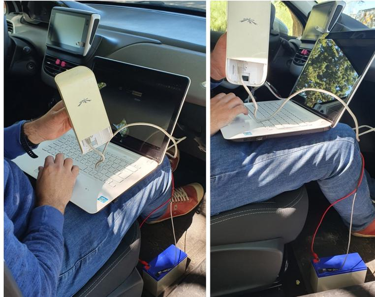
Figura 4.4: Equipamiento a bordo del vehículo para ejecutar el método War-Driving.
