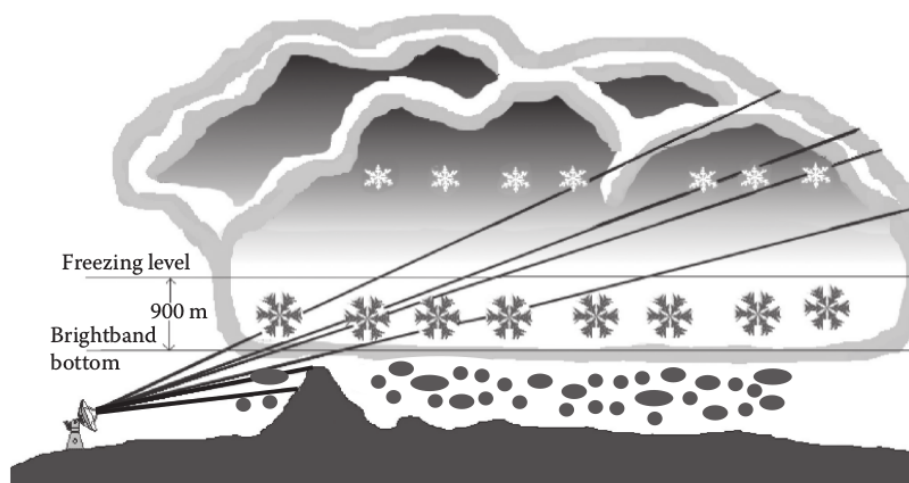
Figura 3.21: Ejemplo de un barrido de radar en presencia de una nube estratiforme precipitante. Se ilustra la estructura de la tormenta y la ubicación de la banda brillante. Gráfica extraída de Jonathan J Gourley y Hong, 2014.
