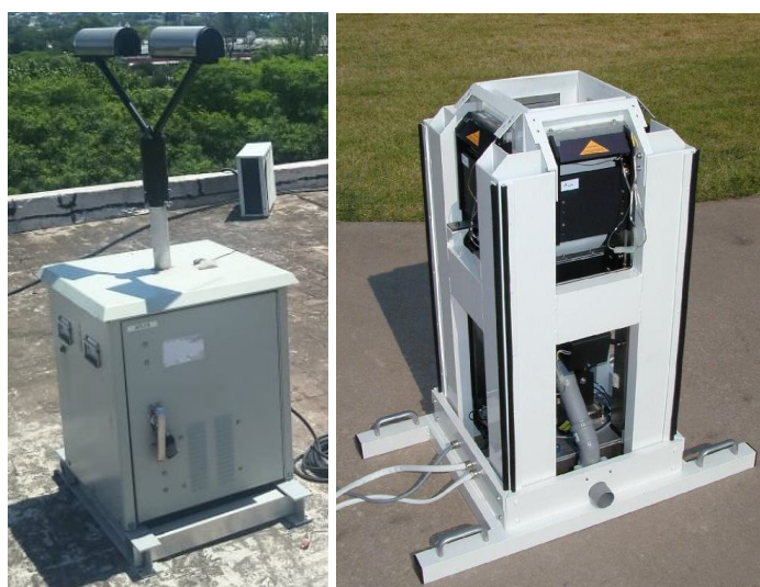
Figura 3.4: (Izq.) Disdrómetro OTT instalado en el techo de la FAMAF de la UNC. (Der.) Disdrómetro 2DVD comercial.
