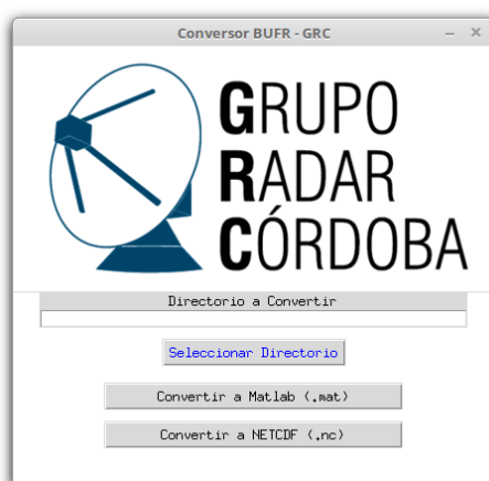
Figura 4.11: GUI del conversor BUFR / NetCDF implementado en 'HIDROMET'. Se convierten de forma recursiva todos los subdirectorios que se encuentren dentro de la dirección de conversión ingresada como parámetro.
