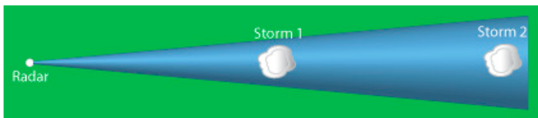
Figura 3.18: Ejemplo del efecto ensanchamiento del haz. Dos tormentas idénticas son registradas con distinta intensidad al ser sensadas con volúmenes de resolución distintos. Imagen extraída de National Weather Service, 2019a.
