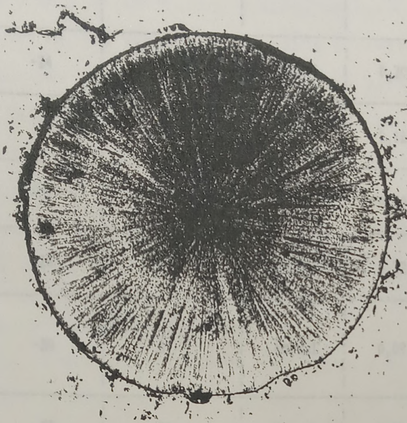
FIGURA 4.5: Densidad uniforme de burbujas en una sección delgada del cilindro 17.
