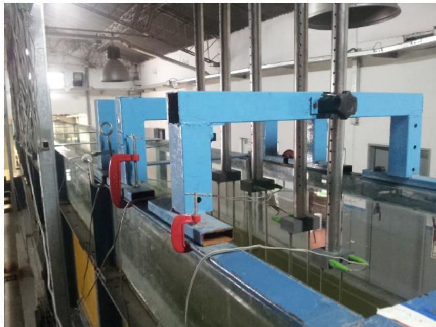
Fig. 22 Sensores sobre el Canal de Oleaje
