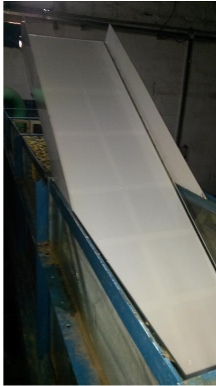
Fig. 25 Estructura lisa de acrílico de pendiente 1V:1,5H.
