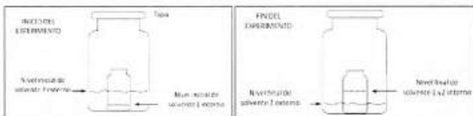
Fig. 4.10. Representación esquemática de la técnica de cristalización por difusión de vapor (Adaptada de Cuhna y col.<sup>162</sup>).
