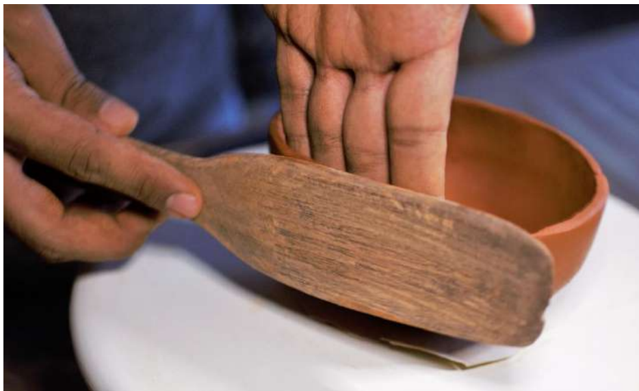
Figura 10.76: Proceso Tecnológico Pormenorizado del Paleteado.
