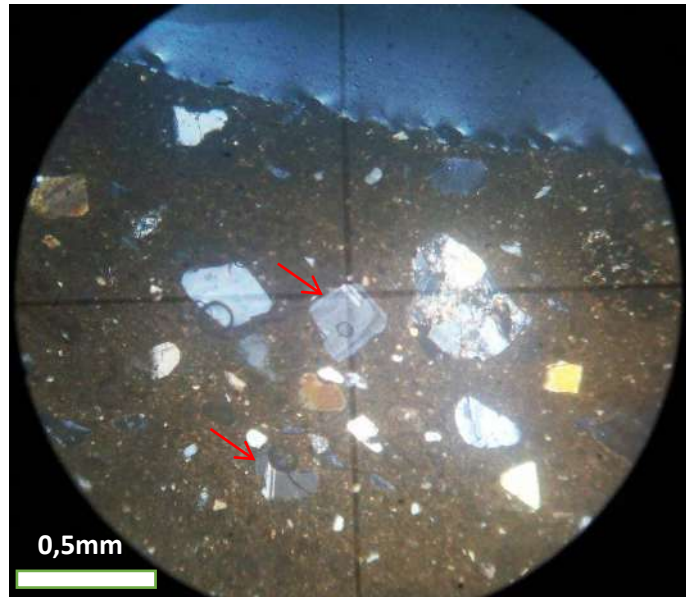
Figura 9.37: Microfotografía del fragmento SaCat04 A, señalando los cristaloclastos de plagioclasas.
