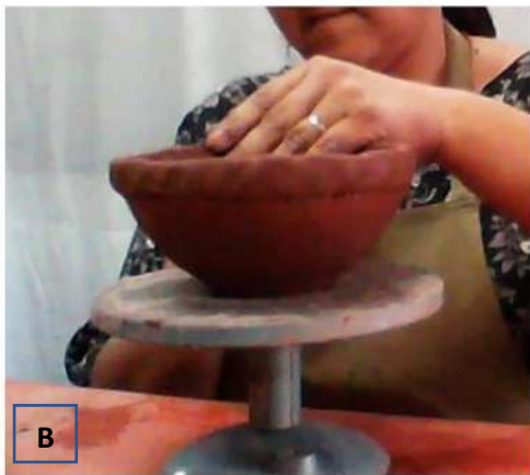
Figura 10.73: Proceso de rodeteado. (A) Elaboración de rodetes; (B) y (C) Incorporación de rodetes superpuestos al cuerpo.
