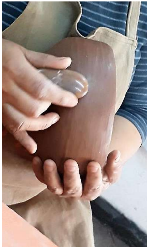
Figura 10.82: Ejecución del Proceso Tecnológico Pormenorizado de bruñido en banda.
