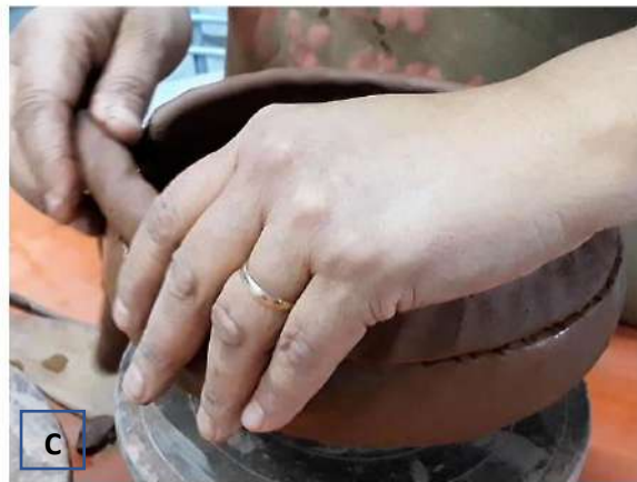
Figura 10.73: Proceso de rodeteado. (A) Elaboración de rodetes; (B) y (C) Incorporación de rodetes superpuestos al cuerpo.
