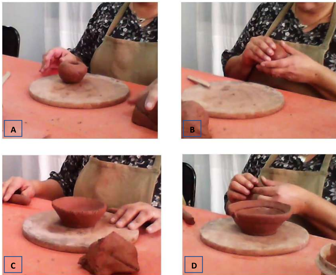
Figura 10.72: Proceso de elaboración de la base a partir del estirado. (A) Bollo de arcilla inicial; (B) Estirado progresivo; (C) Resultado final; (D) Incorporación del primer Rodete de arcilla.
