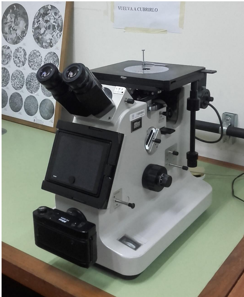
Figura 7.6 Microscopio metalográfico - Laboratorio de Metalografía INTI-Córdoba.
