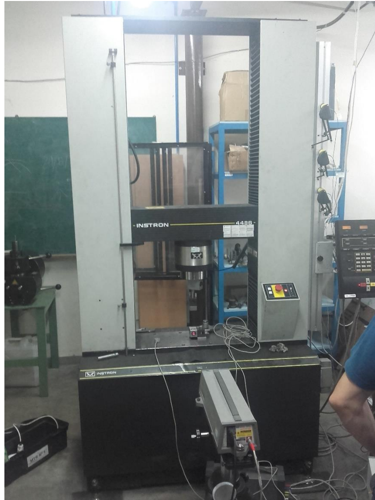
Figura 5.1 Máquina Universal INSTRON - Laboratorio de ensayos mecánicos INTI-Córdoba.
