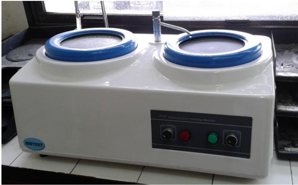
Figura 7.3 Desbastadora metalográfica de dos platos - Laboratorio de Metalografía INTI-Córdoba.
