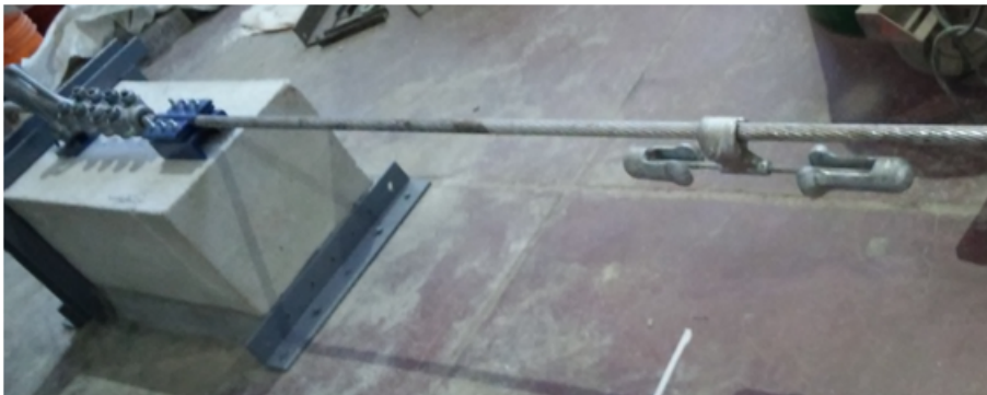
Figure 5.15: Amortiguador montado en el conductor a la distancia calculada l_{ideal}
