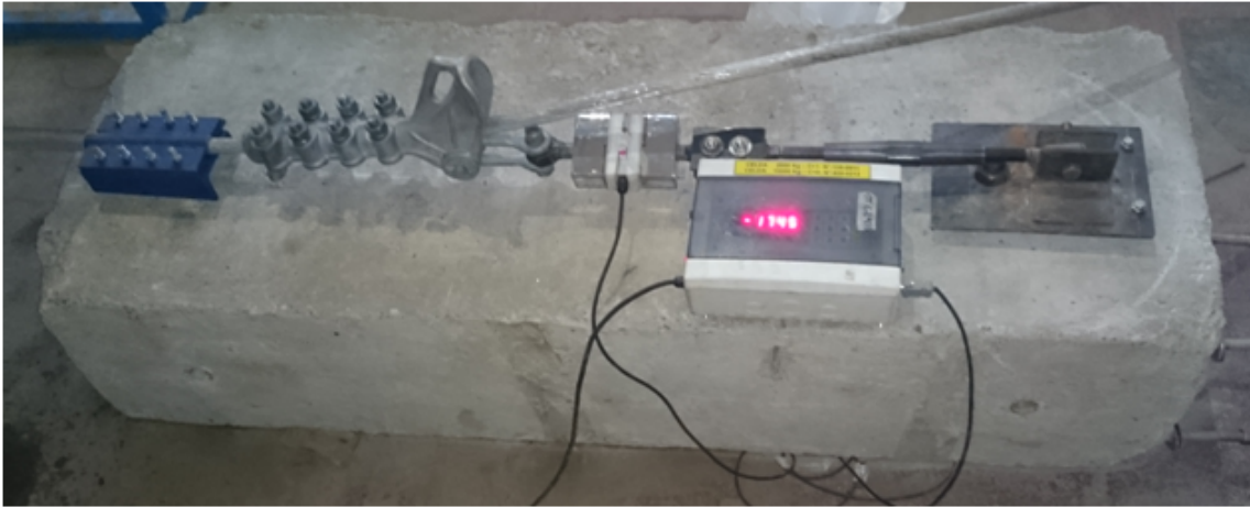
Figure 5.12: Bloque de tensado montado
