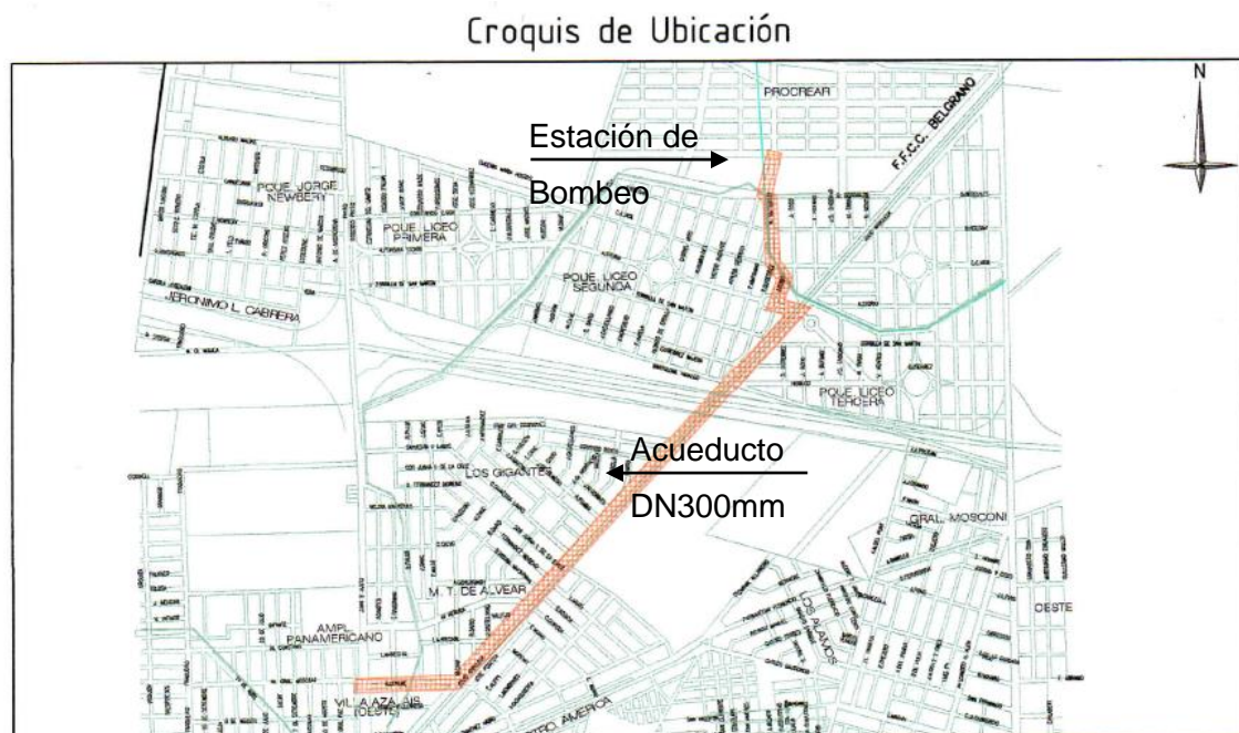
Figura 3.4 - Estación de Bombeo y Acueducto.
