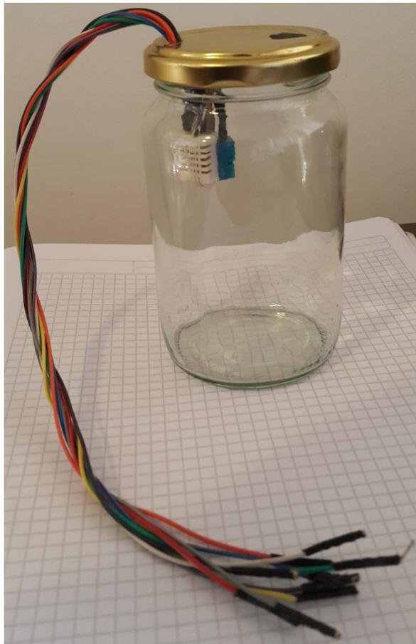
Fig. 3.6.3.1. – Cámara de Ensayos
