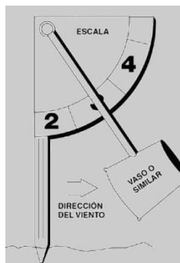
Fig. 4.1.2.1 – Anemómetro de Empuje
