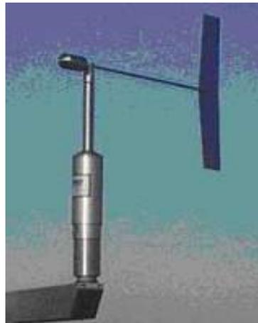
Fig. 4.1.2.3 – Anemómetro de Compresión
