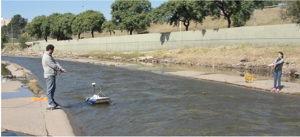
Figura 38: Medición con ADCP en Río Suquía
