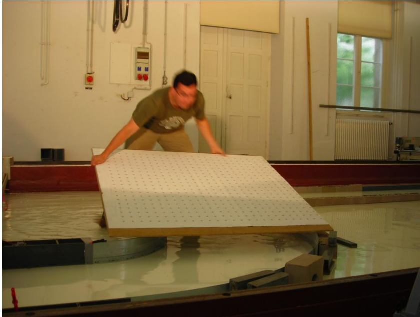
Figura 17: Colocación de grilla en zona de medición (Tarrab, 2008)
