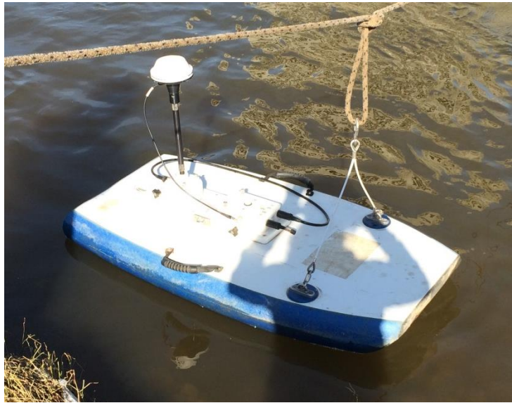
Figura 33: Perfilador de Corrientes Acústico Doppler de la firma Sontek® perteneciente a FCEFyN
