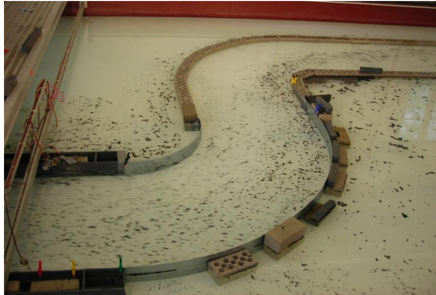
Figura 16: Partículas sembradas durante las mediciones con PTV (Tarrab, 2008)
