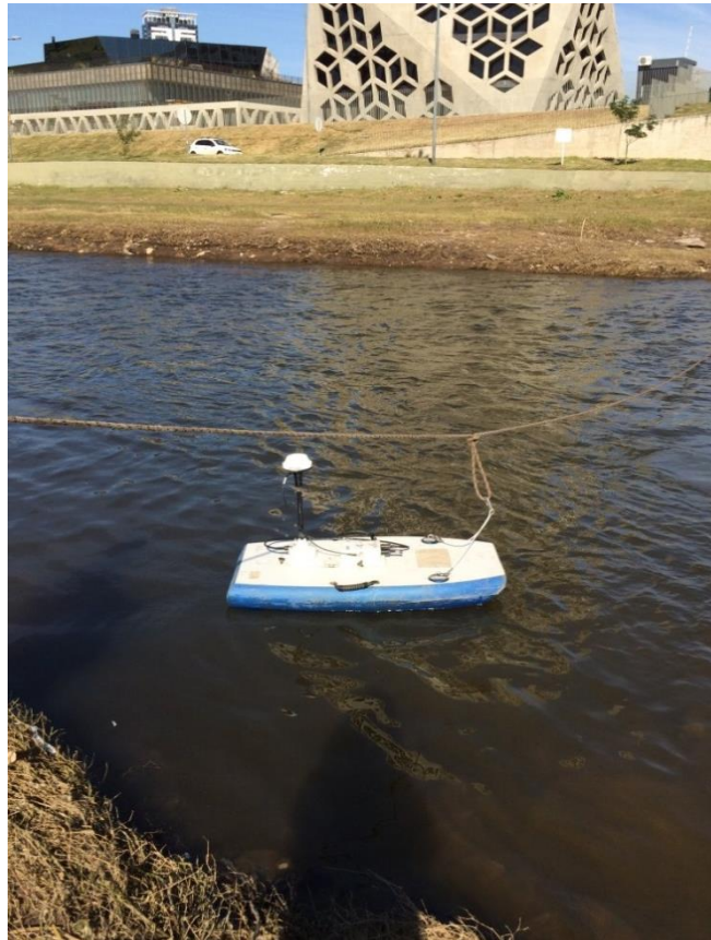
Figura 8: Medición de caudales con ADCP desde plataformas móviles comandadas con cables.
