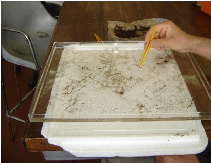
Colocación en bandeja y limpieza de muestras de raíces para luego escanearlas.
