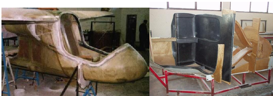
Figura 3y4: Interior del avión AZOR en construcción
