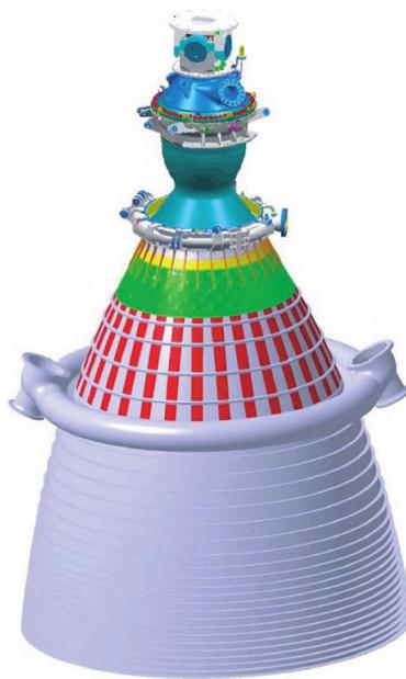
Figura 2.6.1: Cámara de empuje del motor Vulcain 2, Ley et al. (2009)
