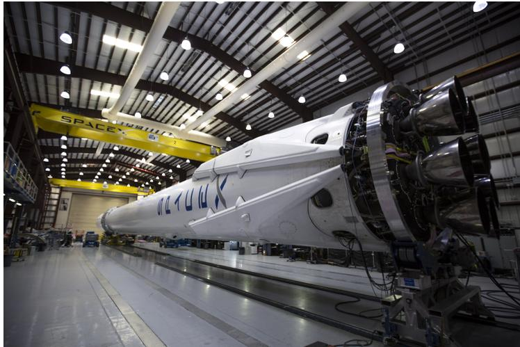
Figura 3.2.3: La primera etapa del cohete Falcon 9 es propulsada por 9 motores Merlin, alimentados por LOX – Kerosene (SpaceX, 2016).
