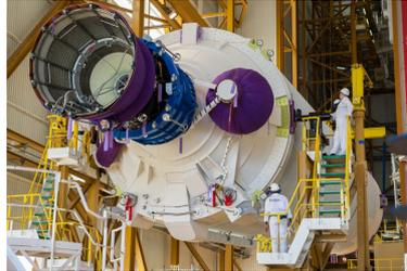
Figura 3.2.2: La etapa principal del cohete Ariane 5 es propulsada por un motor Vulcain 2 utilizando la mezcla LOX – LH<sub>2</sub> (Arianespace, 2016).
