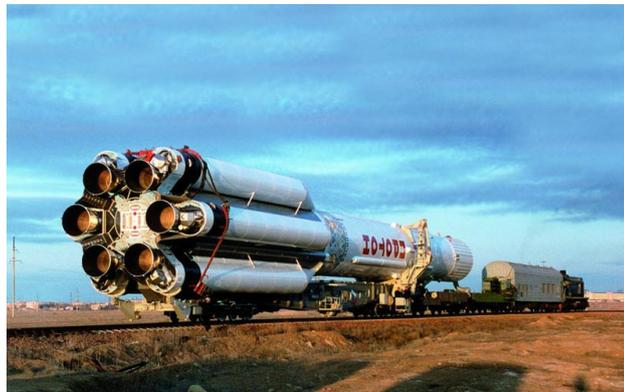
Figura 3.2.1: Cohete Proton M. La primera etapa es propulsada por 6 motores RD-275M, utilizando Tetróxido de Nitrógeno como oxidante y Dimetilhidracina Asimétrica como combustible. Esta última se denomina comúnmente UDMH por su nombre en inglés Unsymmetrical Dimethylhydrazine y es un derivado de la hidracina (Khronichev State Research and Production Space Center, 2016).
