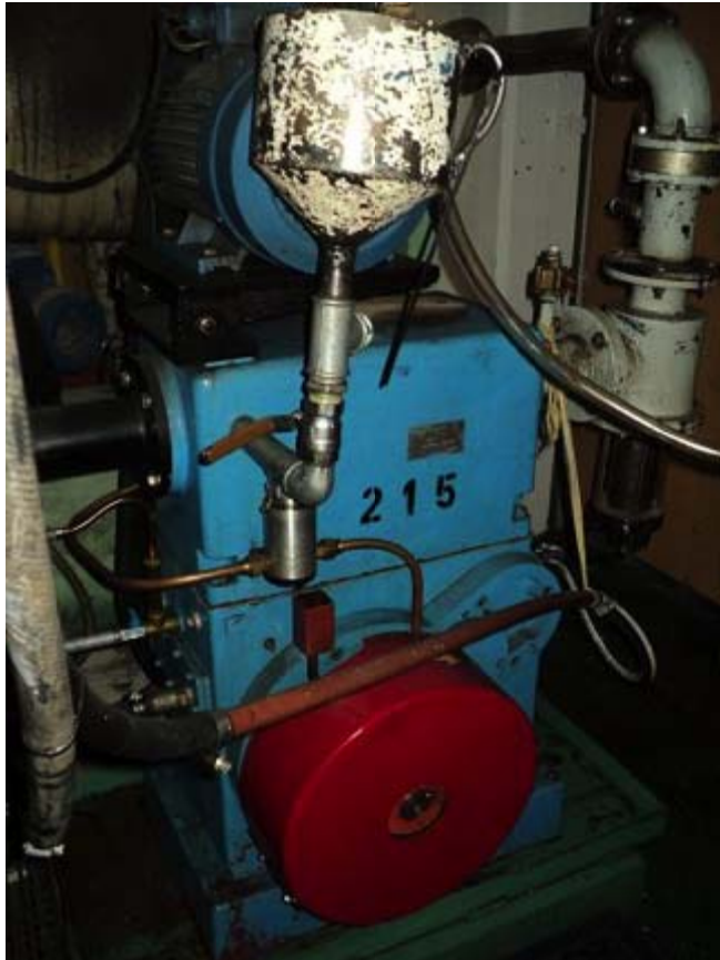
Figura 25: bomba rotativa marca Pfeiffer de 360m 3 /h y 11Kw.
