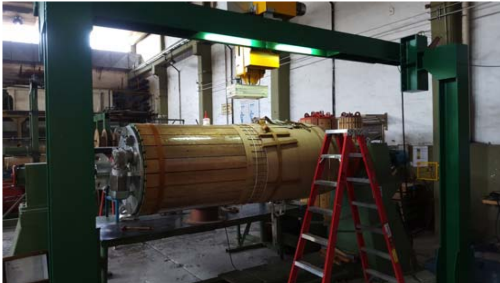
Figura 5: Sala de bobinado. Bobinado del tipo Hélice Múltiple.
