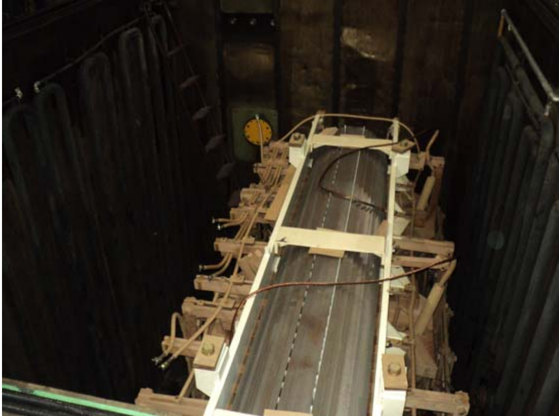
Figura 12: Secado de parte activa en autoclave.
