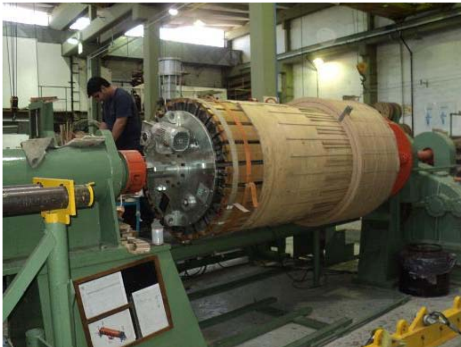
Figura 6: Sala de bobinado. Bobinado del tipo Continuo Entrelazado.
