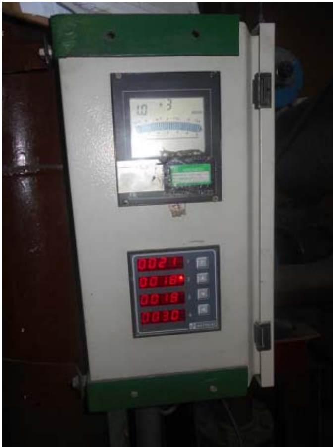
Figura 33: Controlador digital para vacuómetros tipo Pirani. Cuatro canales independientes.
