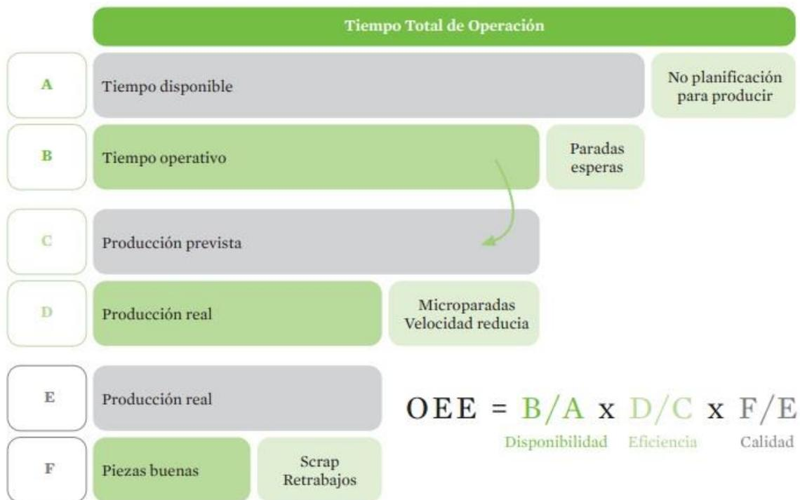
**Figura 2.5** - Descomposición de los tiempos de fabricación (OEE)
