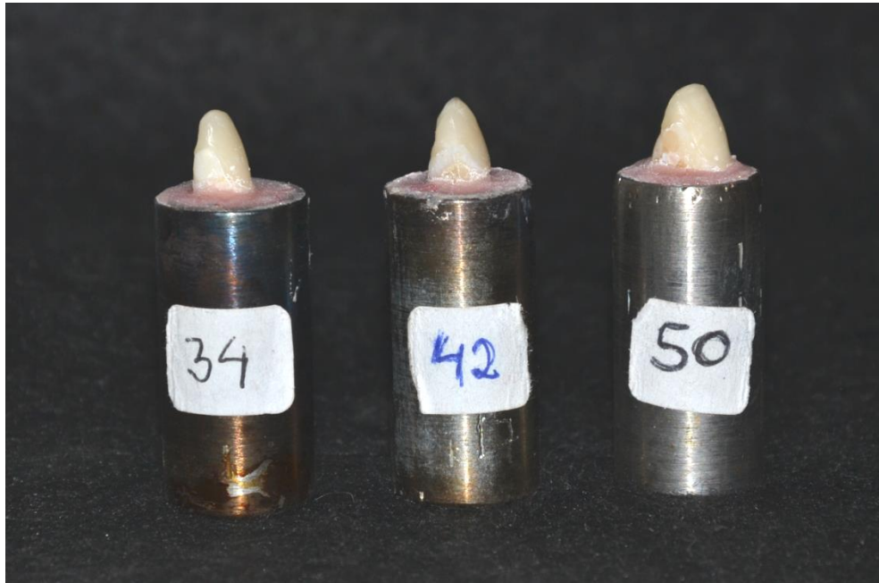
Fig.13 Ubicación de muestras en bloques de acrílico, con refuerzo metálico externo.
