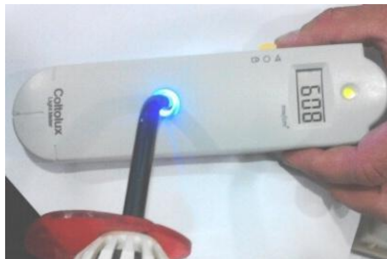
Fig. 12 Control potencial lumínico: potencia no menor de 450 mW/cm 2 (Radiómetro Coltolum)
