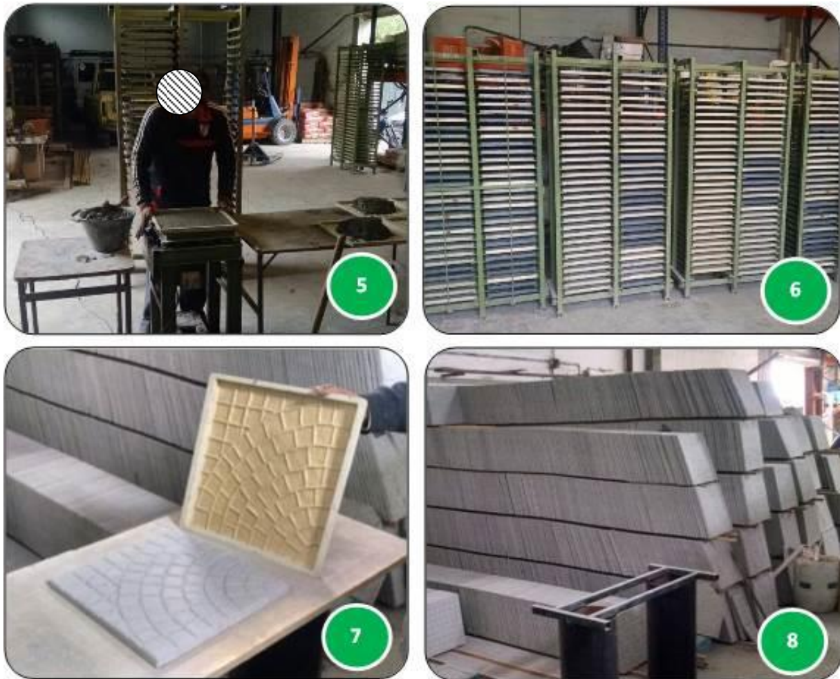
Imagen 2.19 - Flujo productivo de la producción de baldosas (2). -
