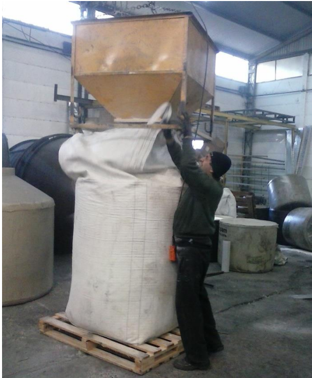
Imagen 25: descarga de material en el bolsón.
