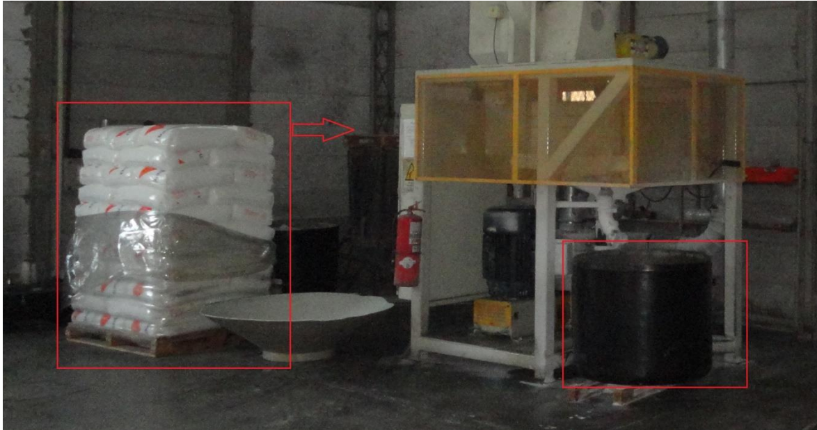
Imagen 14: A la izquierda el material virgen próximo a ser introducido en el cargador. A la derecha el tacho con la materia prima semi elaborada que sale del molino.
