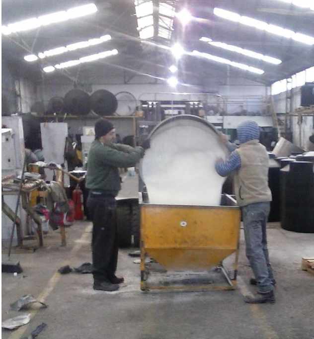
Imagen 23: operarios llenando tolva para cargar bolsón.
