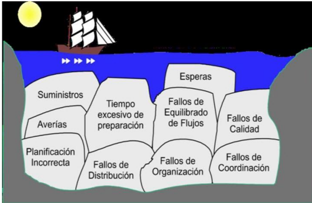
Imagen 13: El nivel del agua (inventario) oculta los problemas
