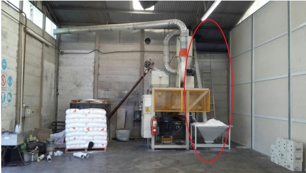
Imagen 39: Nuevo sistema de transporte de MP hacia sector de mezclado.
