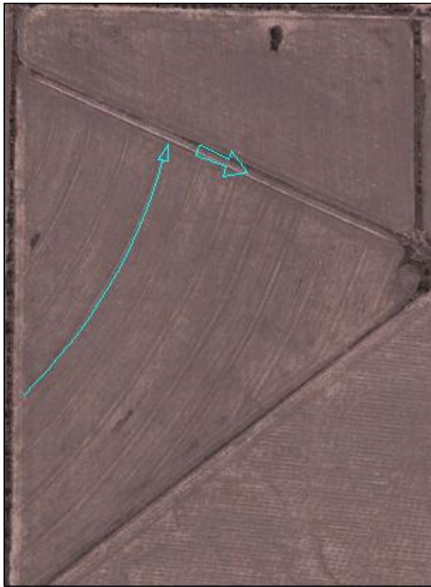
Figura N°29: Terrazas paralelas que desaguan en un canal. Ensayos realizados por el grupo de gestión ambiental de suelo y agua, FCA-UNC.
