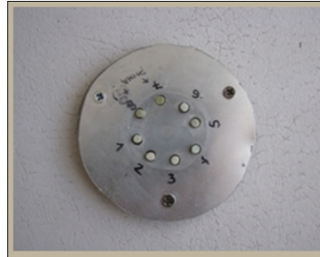
Figura V.8: Platina que contiene 6 muestras del grupo experimental y 2 del control
