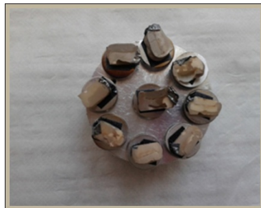
Figura V.16: Metalizado de las muestras. Disposición de las muestras antes del SEM
