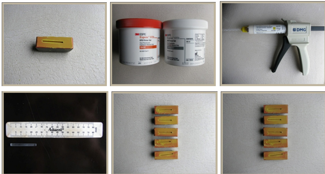
Figura V.4: moldes rectangulares de silicona por adición (Express™ STD 3M ESPE) de 2mm de ancho por 2mm de alto por 25mm de largo
