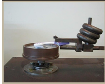
Figura V.7: Máquina que simula el cepillado dental
