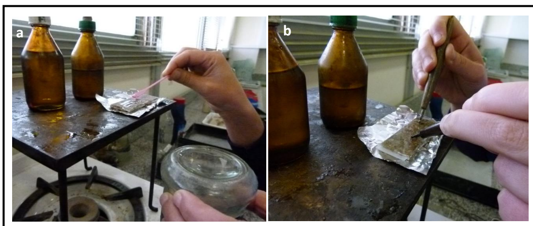
Fig. 11. a) Colocación de la araldita en la cara más lisa de la muestra; b) Pegado de los porta objeto y eliminación de las burbujas.
