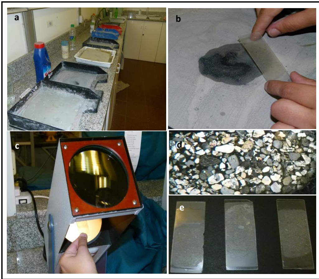
Fig. 13. a) Mesada de abrasivos; b) Pulido del corte; c y d) Vistas en lupa polarizada; e) Láminas delgadas finalizadas.
