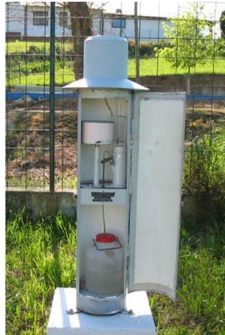
Figura 15: Pluviógrafo
