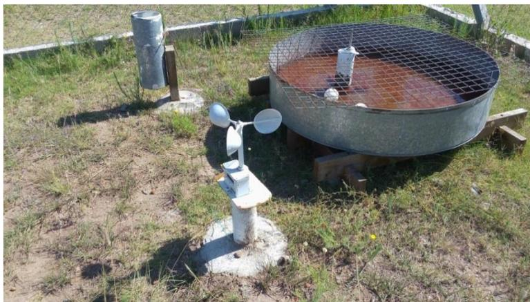
**Figura 21: Unidad evaporimétrica del laboratorio de hidráulica**
