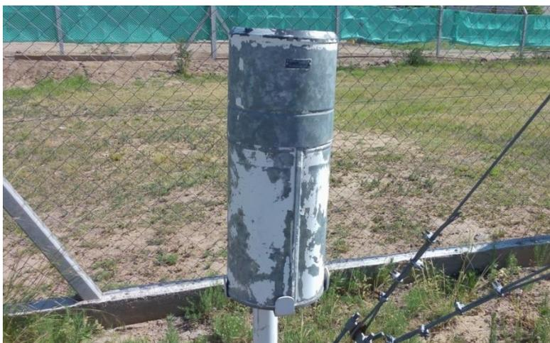
**Figura 23: Pluviómetro tipo B, al lado de pluviómetro de alta frecuencia**
