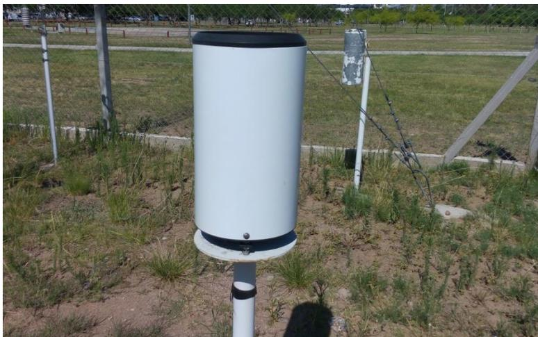
**Figura 22: Pluviómetro de alta frecuencia**
