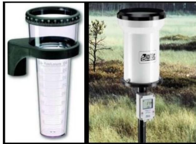
Figura 14: Tipos de pluviómetros
