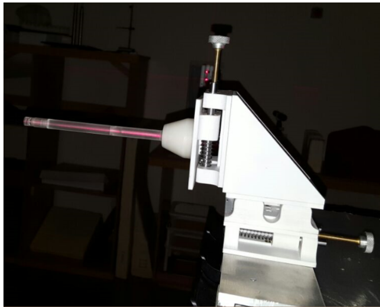
Figura 30. Maniquí alineado con los láser del búnker del linac del HO (vista lateral).
