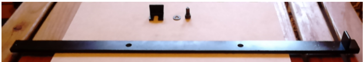
Figura 28. Planchuela con tope soldado en un extremo (parte inferior) y tope móvil junto a su tornillo M8 (parte superior)
