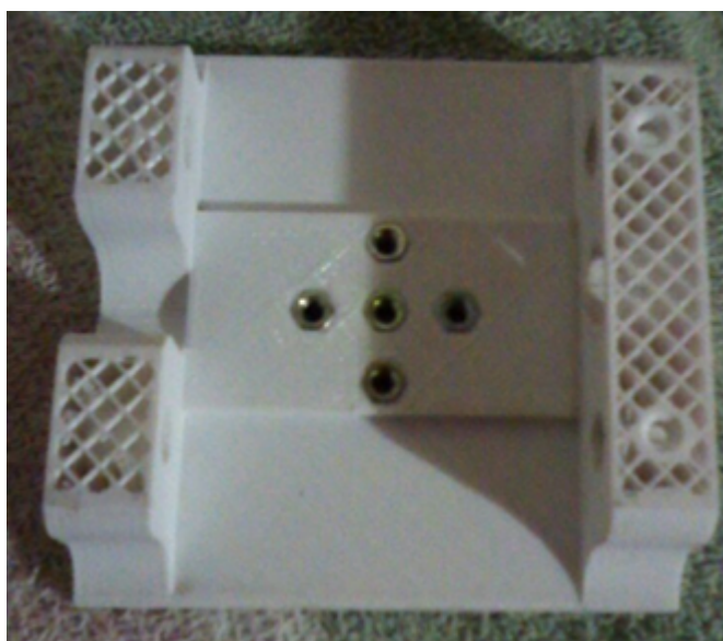
Figura 23. Base rebajada con fresadora.
