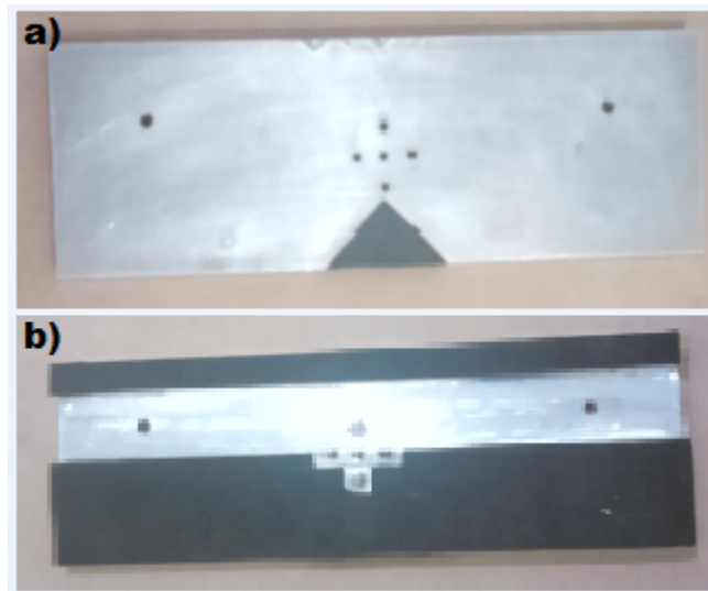
Figura 29. Base de aluminio: a) vista superior con un añadido de goma para cubrir un faltante de material y b) vista inferior con la goma negra de cuatro mm para suplementar.
