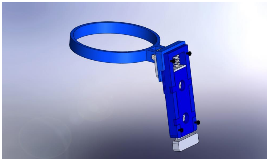
31 - Encastre dispositivo - adaptación para vaso
