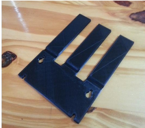
22 - Adaptación para PTM 6000 impresa en 3D.
