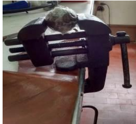
Foto N° 7_Prensa para extracción de aceite
