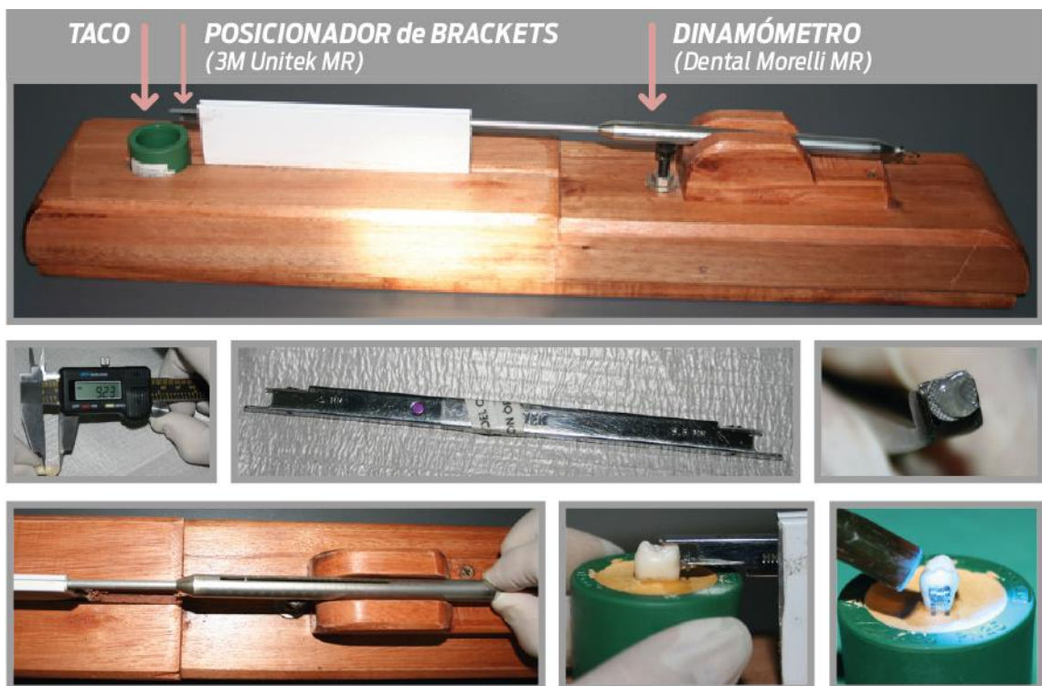
Figura 10. Dispositivo de diseño propio (ver plano en Anexo): A. Calibre para determinar largo corona anatómica. B. Dispositivo para cementar los brackets con igual presión. C. Posicionador para colocar el brackets en el centro de la corona anatómica en sentido ocluso apical.
