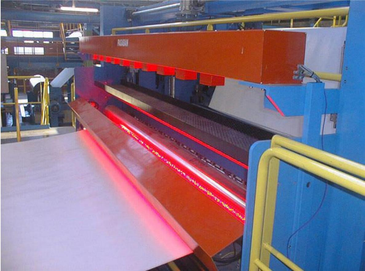
**Figura 46. Sistema de secado por infrarrojo.**
