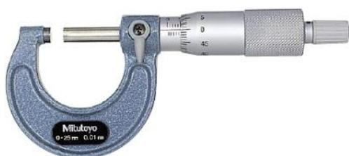
**Figura 13. Micrómetro utilizado para medir el espesor de las muestras**
