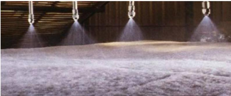
**Figura 45. Sprayado industrial de pasta de celulosa.**
