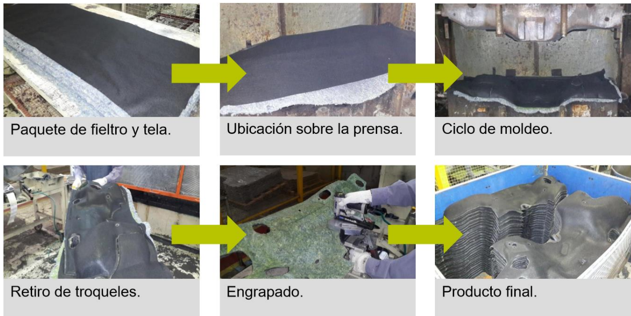
Figura 1-1 Proceso de fabricación Outer Dash Insulator.
