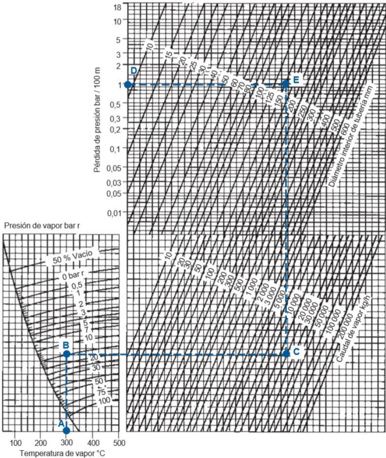
Gráfico 5-4 Dimensionamiento de tuberías de vapor saturado y sobrecalentado (método de la caída de presión). Spirax Sarco (1999). Guía de referencia técnica: Distribución del vapor . [Gráfico].
