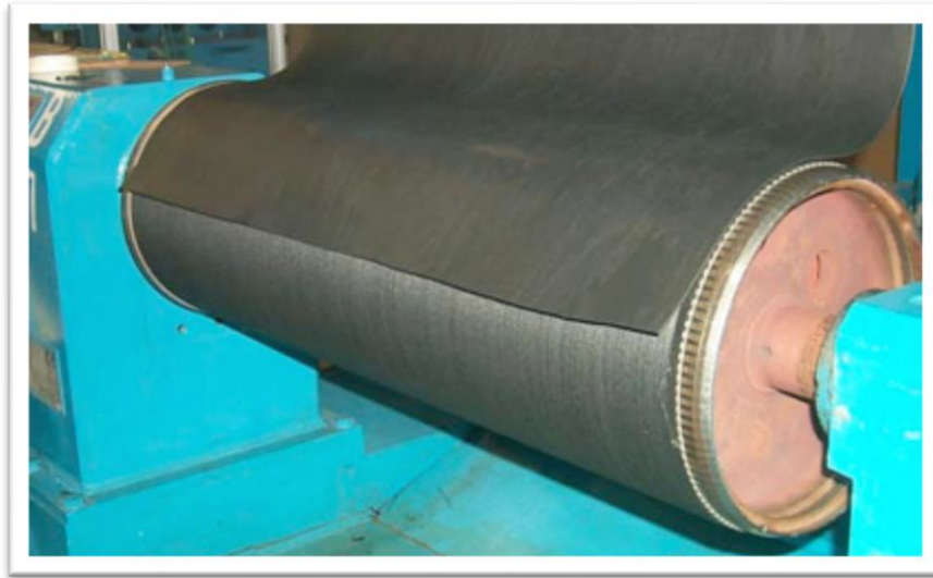
Fig. 2.9 Colocación de la goma que va a ser enrollada sobre el molde
