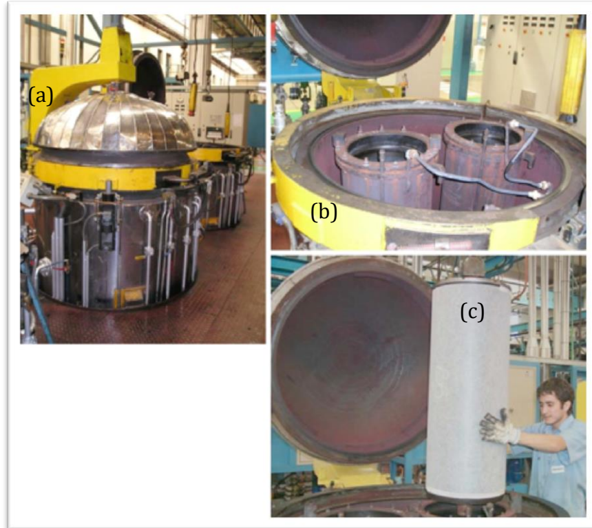
Fig. 2.12a, 2.12b y 2.12c Autoclaves (a) con sus respectivos contenedores en el interior (b), donde en cada uno se inserta el molde confeccionado (c).
