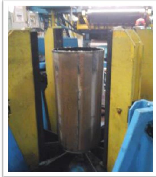
Fig. 2.28 Manchón de correas luego de haber sido extraído de su molde.
