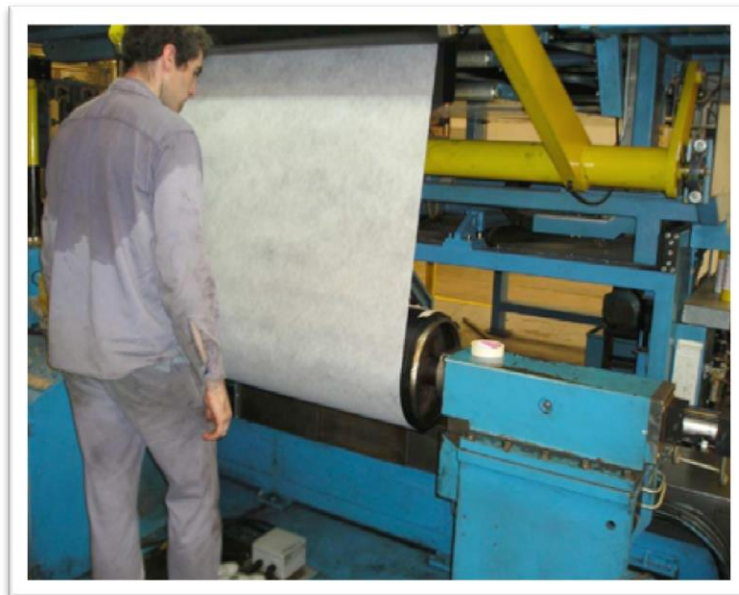
Fig.2.10 Giro de papel Woven no Woven sobre el molde
