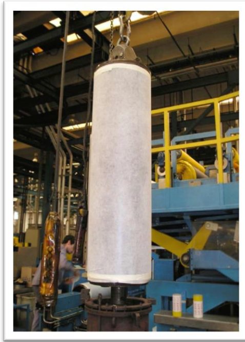
Fig.2.11 Estructura tubular finalizada recubriendo el molde dentado.
