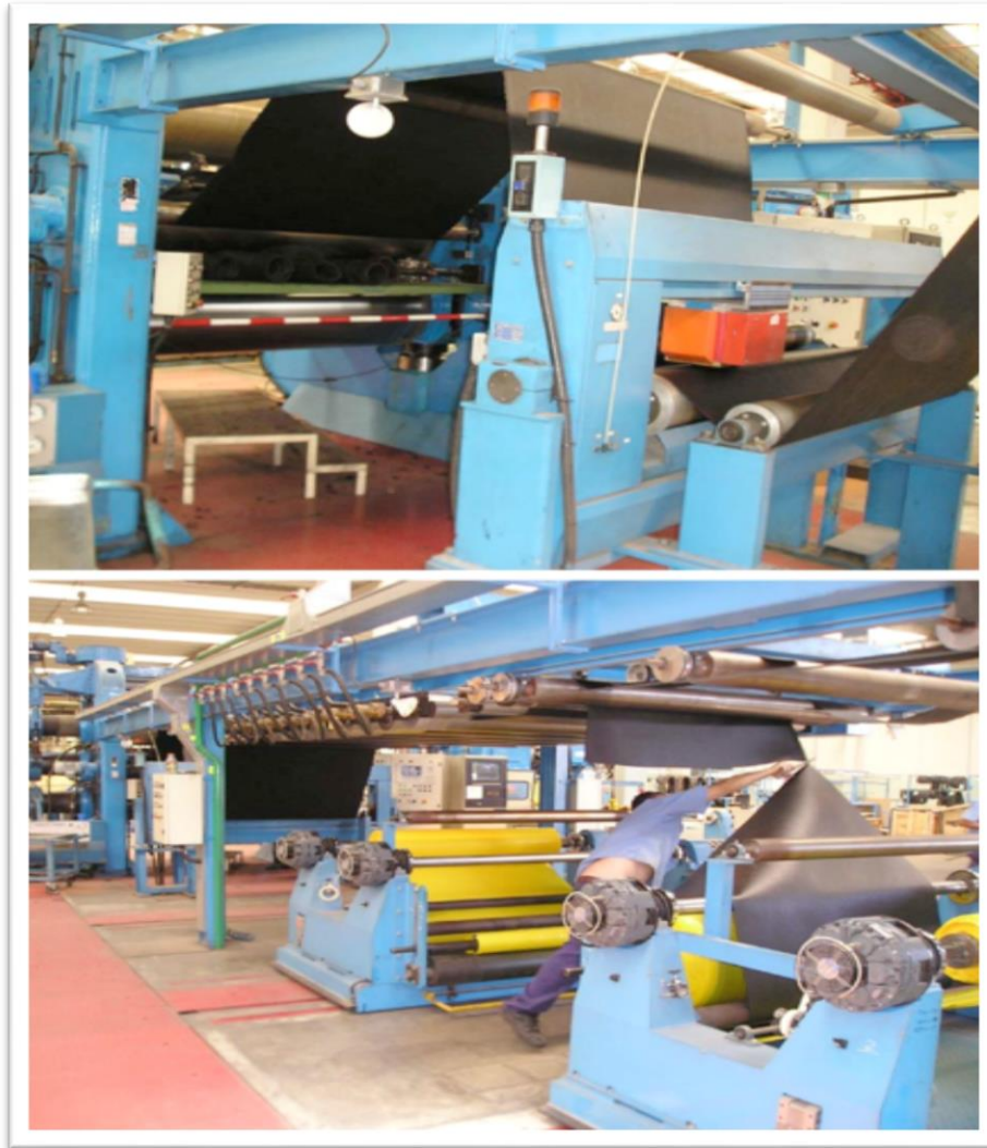
Fig. 2.3 Balas de goma atravesando los diferentes rodillos de la calandra
