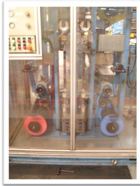
Fig. 2.4 Bobinas de hilo (roja y azul) en el festón, donde se regula la tensión.
