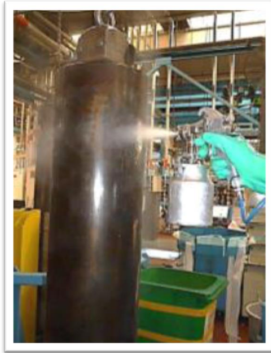
Fig. 2.25 Molde de correas poly-v rociado con solución antiadherente.
