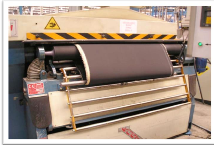
Fig. 2.16 Manchón durante el proceso de rectificado.
