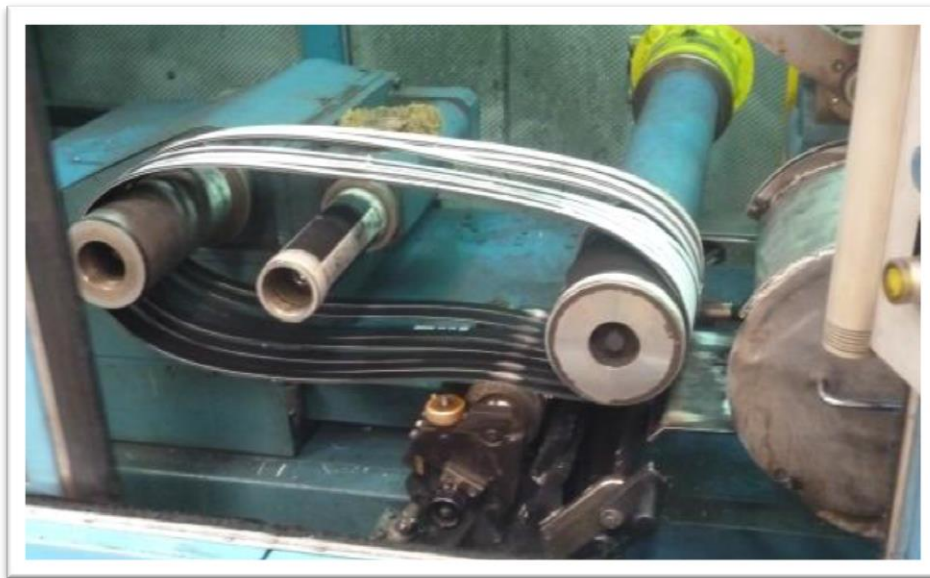
Fig. 2.30 Fly-Cut en pleno proceso de fresado de las correas, aquí adquieren las nervaduras longitudinales.
