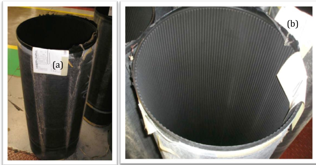
Fig. 2.15a y 2.15b Manchón de correas listo para ser rectificado.
