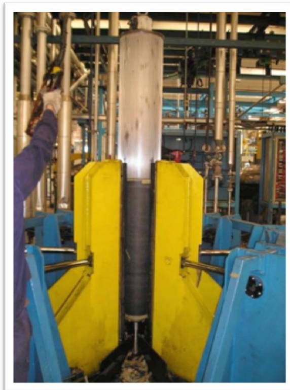
Fig. 2.13 Molde confeccionado extrayéndose del contenedor luego del proceso de vulcanizado.
