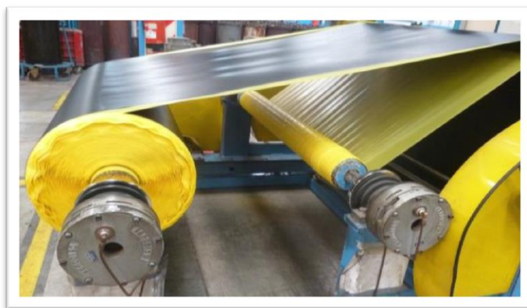
Fig. 2.24 Rollo obtenido (con polietileno entre capa y capa) luego de ser girado 90 grados.
