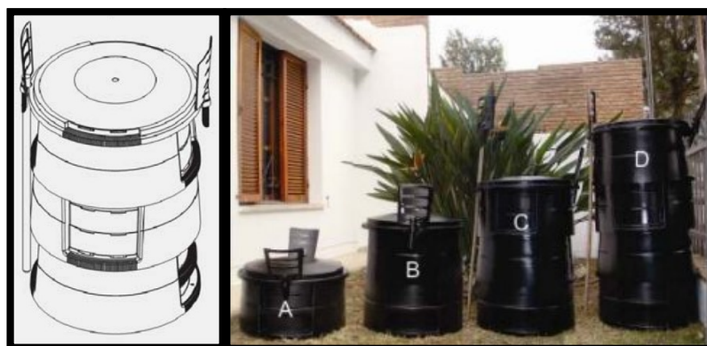
Fig. 2.4. Diseño industrial (Registro N° 82.758) aplicado a compostadores de pequeña escala y esquema modular de utilización.
