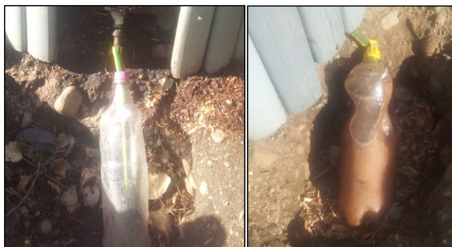
Fig. 4.1. Recolección de líquidos lixiviados compuesto por compartimento receptor de líquidos en compostador con válvula de cierre y envase receptor de 1,5 l.
