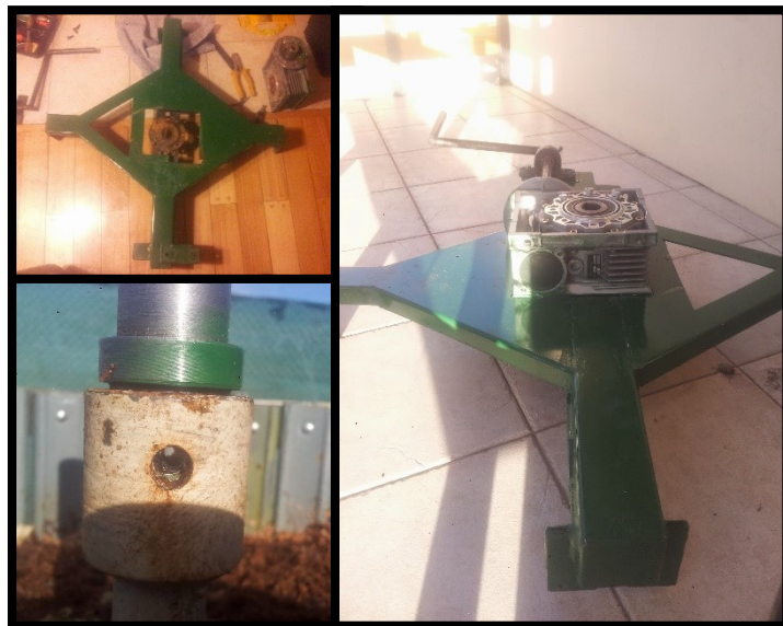
Fig. 2.16. Mejoras aplicadas en al segundo soporte y caja reductora utilizada durante la prueba piloto y mecanismo de acople entre dicho componente y el eje mezclador.
