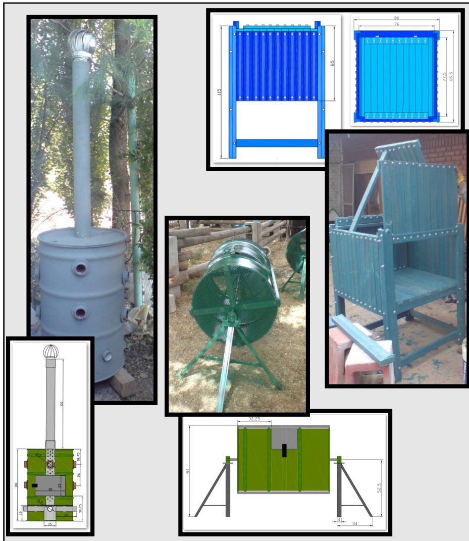
Fig. 2.1. Diferentes prototipos de compostadores utilizados en ensayo previo (Arrigoni, 2011). La evaluación del desempeño de los compostadores tuvo en consideración la efectividad y practicidad de diferentes mecanismos de homogenización o exposición al aire de la mezcla.
