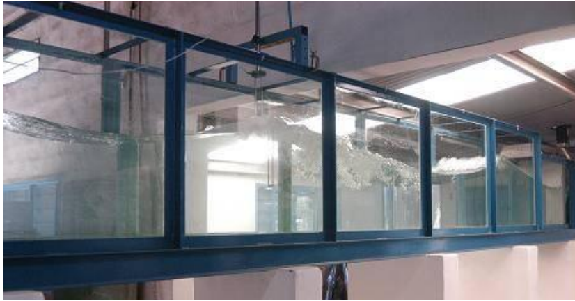
Figura 18. Canal de oleaje del Laboratorio de Hidráulica de la UNC
