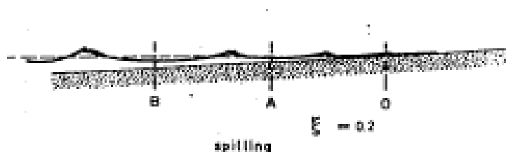
Figura 4. Rotura tipo decrestamiento
