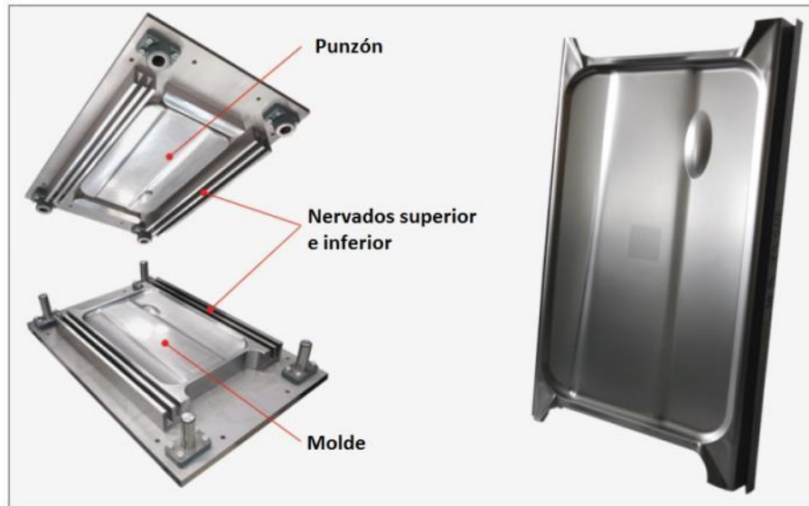
Figura 11: Ejemplo de moldes y piezas obtenidas con el SCS.
