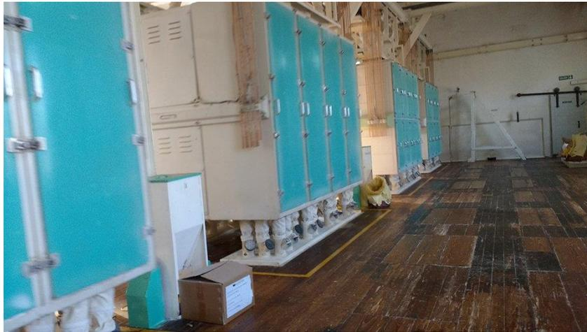
**Figura 26:** Planchister en el Molino Fénix
