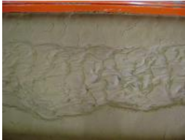
Figura 43: Tendencia a la formación de barras, fotografía tomada luego de 40 hs de ensayo aprox. Con un caudal 0.63 \text{ l/s} y una pendiente de 2.5 \times 10^{-3}
