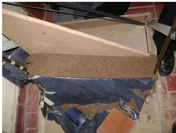
Figura 21: Dispositivo para generar las superficies de arena con inclinación conocida, para realizar los relevamientos con distanciómetro láser
