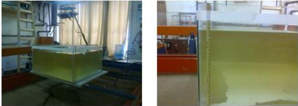
Figura 69: Recipiente prismático de vidrio construido para realizar mediciones controladas a través de agua con el sensor de movimiento
