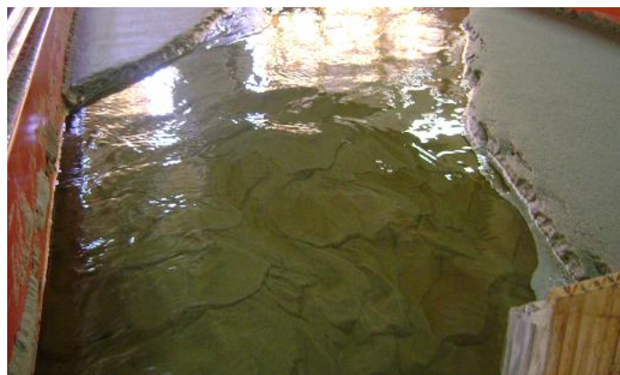
Figura 49: Ancho insuficiente del canal experimental en ensayo realizado con la Geometría 1
