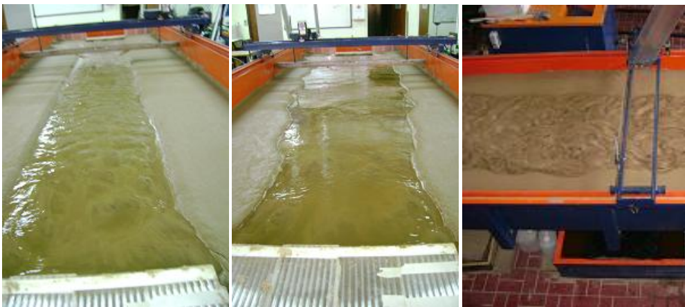
Figura 39: Sección del canal a 2 hs del comienzo (izquierda), 14hs (centro) y sección final (derecha)
