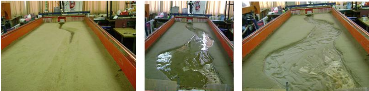
Figura 54: Sección inicial a la izquierda (Geometría 6), en el centro a las 30 hs de ensayo y a la derecha, la sección erosionada donde finalmente se alcanzó el equilibrio hidrosedimentológico (48 hs de ensayo)
