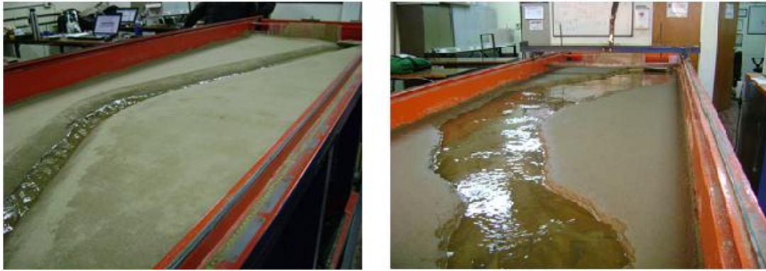
Figura 52: a la izquierda la sección inicial y a la derecha la sección erosionada poniendo en evidencia el ancho insuficiente
