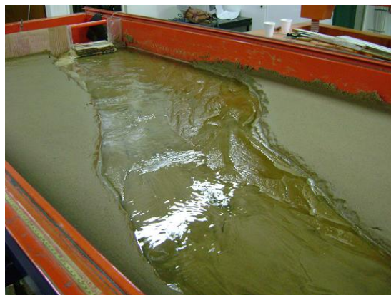
Figura 47: Ancho insuficiente del equipo experimental en el primer ensayo realizado con la Geometría 1
