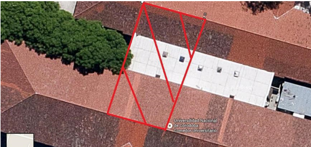
Figura 5.31 - Área de aporte de caño pluvial 2
