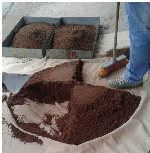
Ilustración 16: Cuarteo de la muestra.
