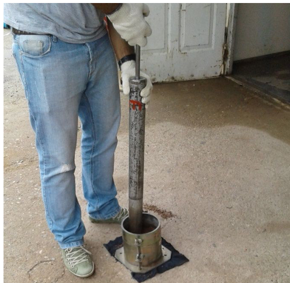
Ilustración 20: Ejecución de ensayo Proctor
