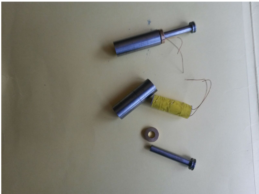
Figura 5-2. Electroimanes principales fabricados y bobinados, uno armado y otro no
