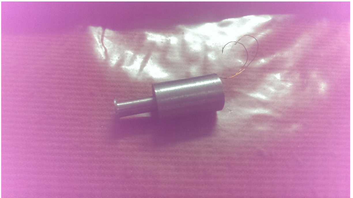
Figura 1-4. Primer prototipo de electroimán, conjunto armado y bobinado
