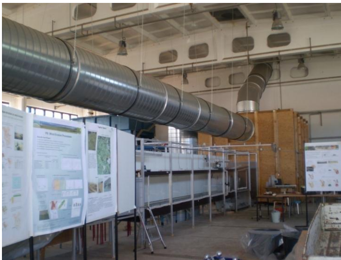
Figura 2.7. Vista general del túnel de viento del Leibniz Centre for Agricultural Landscape Research (ZALF), Müncheberg, Alemania.
