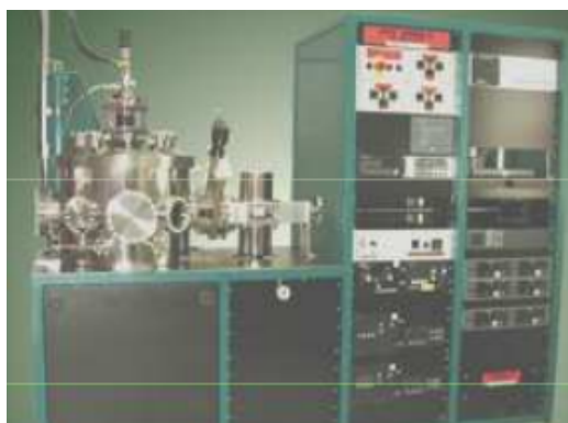
Figura 4.1: Equipamiento de deposición con magnetrón del LCN-UFRGS.
