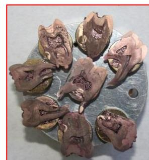
Figura 14: Muestras metalizadas en oro y montadas en stub para observación en MEB.
