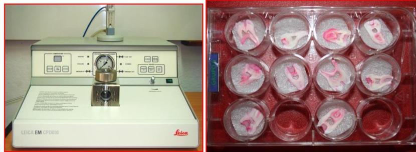
Figura 11: Secador por punto crítico, Leica EM CPD030 Figura 12: Muestras procesadas por punto crítico.
