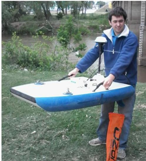
Figura 49: Calibración de la brújula del GPS del ADCP.
