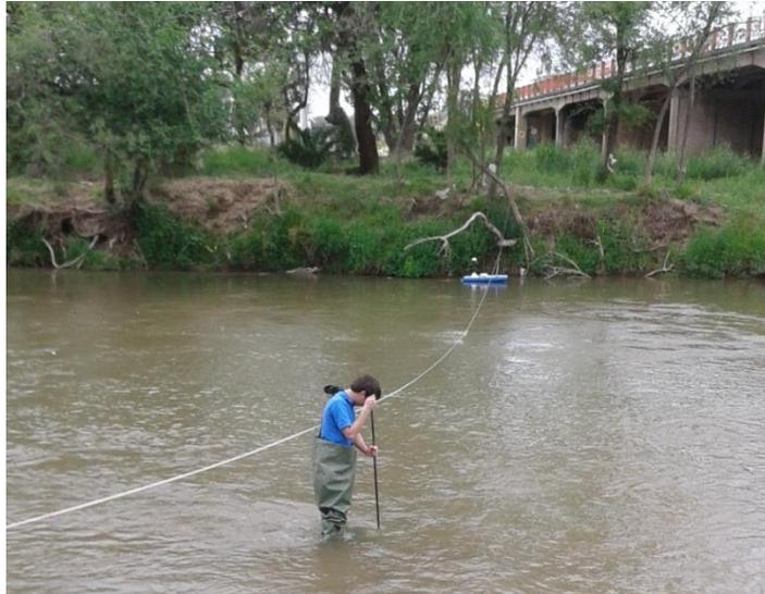
*Figura 52: Medición con el muestreador DH - 48.*
