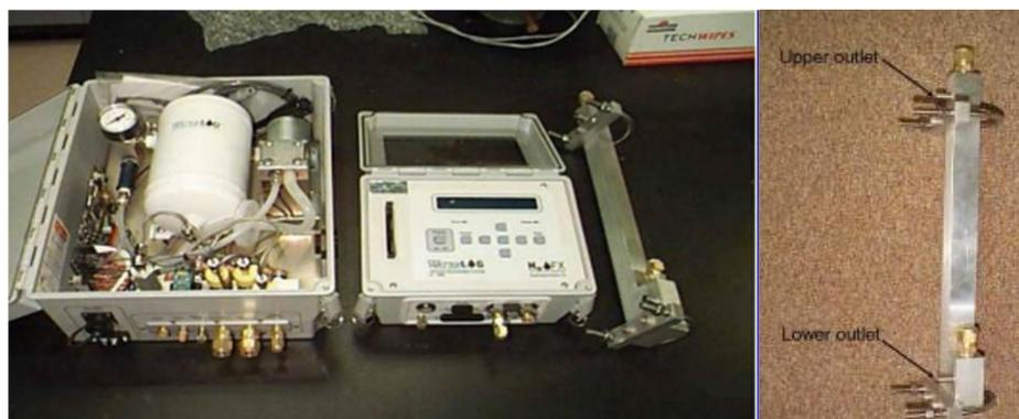
Figura 23: Estimador de sedimentos por diferencia de presiones.
