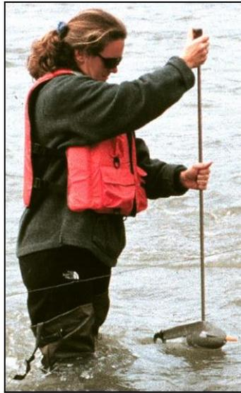
Figura 16: Estimador de transporte en suspensión tipo DH-48.
