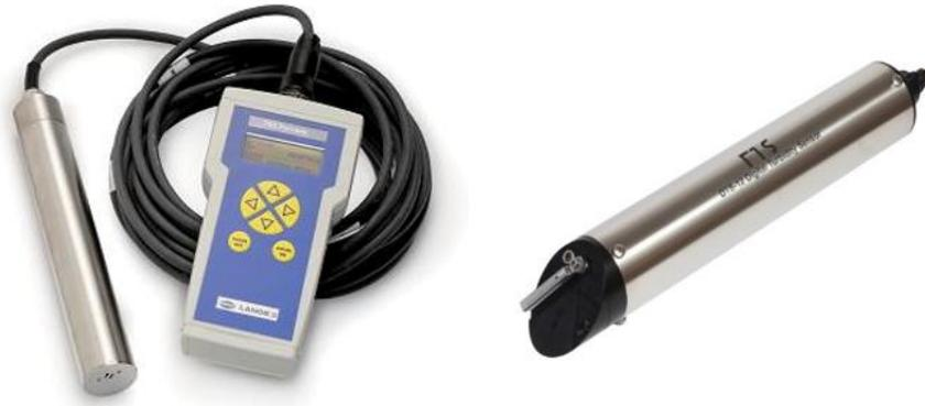
Figura 19: Turbidímetro.
