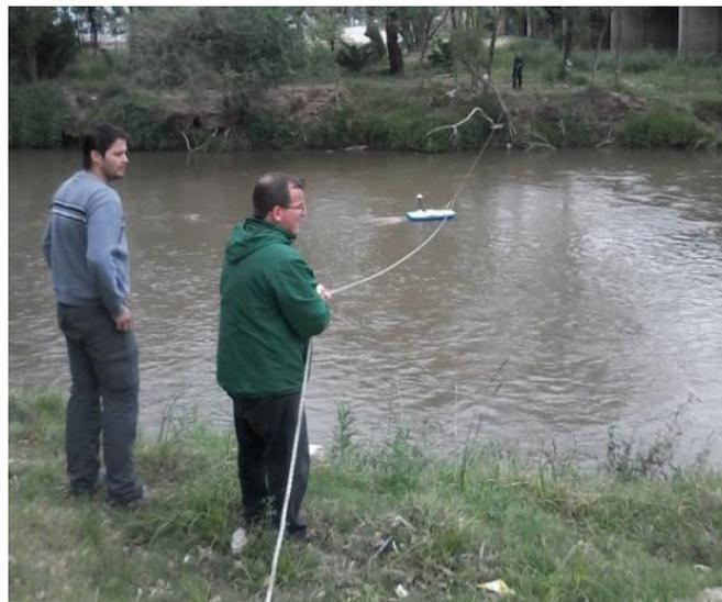
*Figura 51: Ubicación del ACP en una medición estacionaria.*
