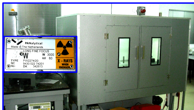
Figura 2.1: Línea de imágenes por contraste de absorción ubicada en las instalaciones del LIIFAMIR ® .
